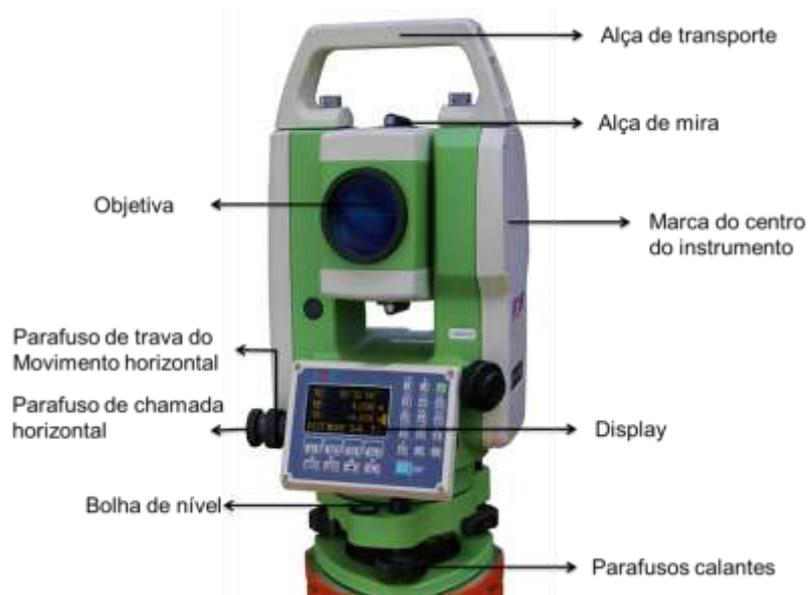
Figura 7 - Detalhamento Estação Total
