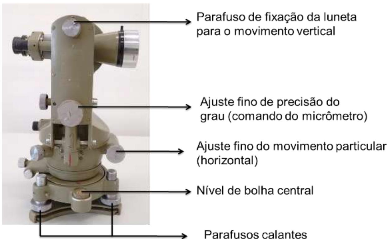
Figura 17 - Detalhamento do Teodolito
