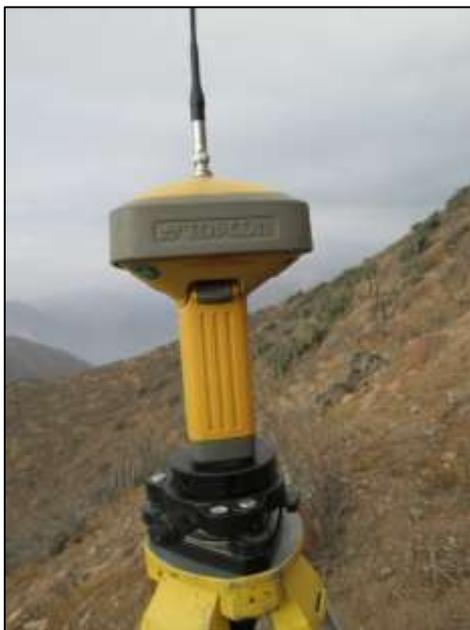
Figura 9- GPS Geodésico Topcon Modelo GR5
