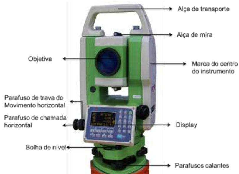
Figura 7 - Detalhamento Estação Total
