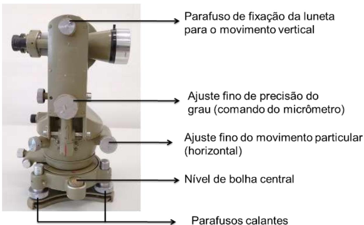
Figura 17 - Detalhamento do Teodolito
