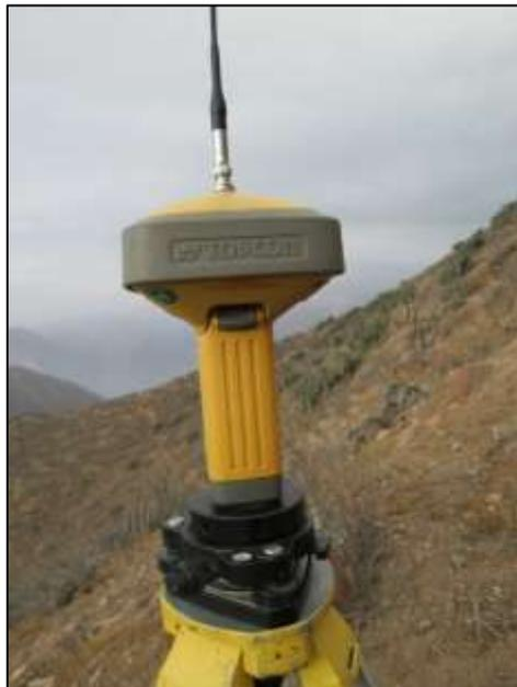
*Figura 9- GPS Geodésico Topcon Modelo GR5*
